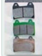
Die Mischung macht's. Bremsbeläge tragen durch ihre unterschiedlichen Bestandteile signifikant zu Bremsleistung, Dosierbarkeit und Fadingverhalten bei. Wie man auf dem Foto links sieht, hat jeder Belag für ein- und dieselbe Bremsanlage eine andere Zusammensetzung. Bei Bedarf lassen sich fast alle Bremsen mit passenden Nachrüstbelägen optimieren
