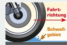
Bei hohem Wasserstand bildet sich vor dem Vorderrad ein Wasserschwall, der sich wie ein Keil zwischen Reifen und Straßenoberfläche schiebt. Ist der Wasserdruck höher als der Anpressdruck des Reifens, entsteht Aquaplaning.
