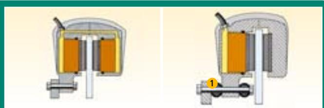
Die **FESTSATTELbremse** hat sich im Lauf der Jahre durchgesetzt. Dabei werden in dem steifen, meist aus zwei Teilen verschraubten Gehäuse auf jeder Seite ein (Zweikolbenbremse), zwei (Vierkolbenbremse) oder gar drei Kolben (Sechskolbenbremse) mit dem hydraulischen Druck auf die Bremsbeläge gepresst.
