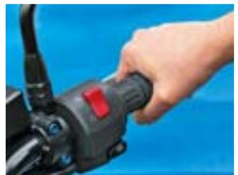
Bei ausgestreckter Hand zu Brems- und Kupplungshebel sollten Unterarm, Handfläche und Finger des Fahrers eine Linie bilden
