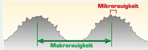
Die so genannte Mikrorauigkeit (rot), deren Rautiefe zwischen 0,001 und 0,1 Millimetern liegen kann, verbessert die Haftung speziell bei Nässe entscheidend, während die Makrorauigkeit (grün) zwischen 0,1 und 10 Millimetern angesiedelt ist und überwiegend die grobe Verzahnung bei trockener Straße verbessert.
