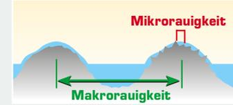
Die makrorauen Erhebungen im Asphalt lagern das Regenwasser zwar ein, für satten Grip und Verzahnung sorgen jedoch nur die mikrorauen Spitzen, die sich durch den Wasserfilm in den Gummi bohren und so einen „trockenen“ Kontakt herstellen.
