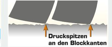
Eine ähnliche Funktion kommt den Lagern der Profilblöcke zu. Durch die Querkraft verschiebt sich der Gummiblock, die Kanten drücken sich dann durch den Wasserfilm auf den Asphalt, weshalb sich Regenreifen an den Kanten am stärksten abnutzen.
