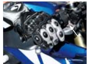
Die Reichweite zum Bremsgriff wird meist über eine Rastermechanik (Pfeil) justiert. Packt die ganze Hand zu, kann die Reichweite verkürzt werden
