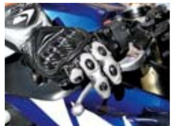
Wer mit nur zwei Fingern bremsst, benötigt meist eine größere Reichweite, damit die Finger, die den Lenker umfassen, nicht eingeklemmt werden
