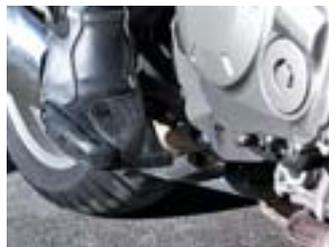
Der Fußbremshebel sollte so tief justiert werden, dass der Fuß locker auf dem Hebel ruht und dieser bei Bedarf sofort aktiviert werden kann
