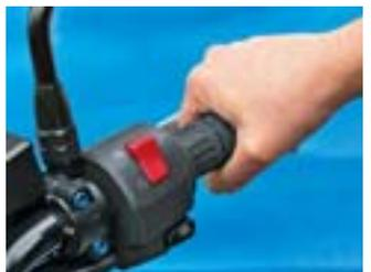
Motoren mit harten Lastwechselreaktionen lassen sich besser kontrollieren, wenn das Spiel im Gaszug auf ein bis zwei Millimeter reduziert wird
