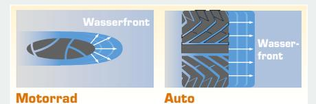
Klare Vorteile beim Motorrad, nicht nur wegen der geringeren Aufstandsfläche des Reifens (links) im Gegensatz zu den Breitreifen der Autos (rechts), sondern auch aufgrund der abgerundeten Kontur. Sie drückt den Wasserschwall überwiegend zur Seite und bahnt so dem Reifen einen Weg durch die Wasserfront, während die flächige Kontur des Autoreifens eine breite Wasserfront direkt in Fahrtrichtung aufbaut.
