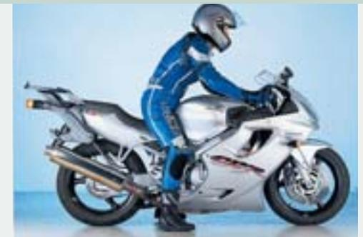
Sicheres Gefühl: Nach dem Einbau eines im Zubehörhandel erhältlichen Tieferlegungskits mit längeren Zughebeln sowie der um zehn Millimeter durch die Brückengeschobenen Gabelholme verringert sich die Sitzhöhe um rund 40 Millimeter
